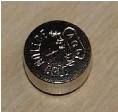
Hier sehen Sie eine Batterie nichteuropäischer Herkunft. Meist sind die Abmessungen nicht eingehalten, damit weist das Hörgerät den "An-Aus-Effekt" auf. Diese Quecksilberbatterie darf in Deutschland nicht für Hörgeräte verkauft und verwendet werden.
